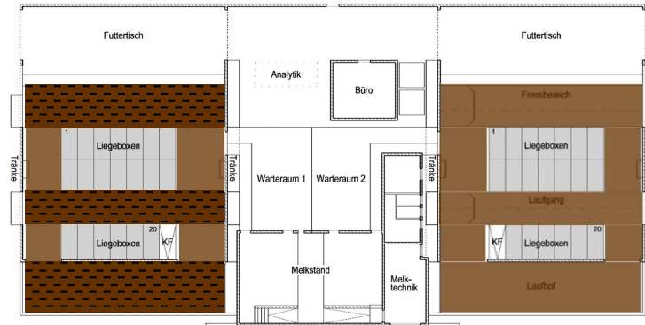
Messungen zur Minderung vom Ammoniakemissionen in der Milchviehhaltung: Übersicht über bauliche Varianten im Bereich Laufflächen Schrade et al. 2023 BFL – Berateratung © Agroscope
