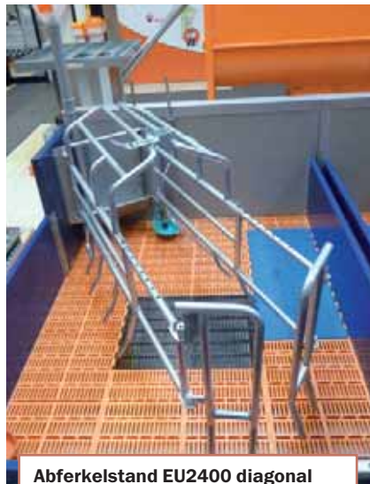
Abferkelstand EU2400 diagonal (Big Dutchman) mit freitragendem Ferkelschutzkorb: Die Bodenvariante hat sich in der EU bewährt.
