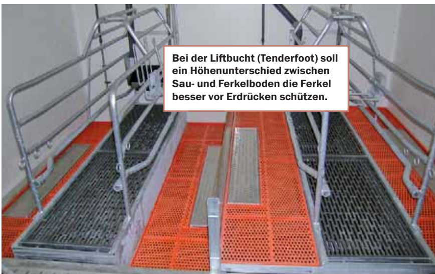
Abferkelstand EU2400 diagonal (Big Dutchman) mit freitragendem Ferkelschutzkorb: Die Bodenvariante hat sich in der EU bewährt.
